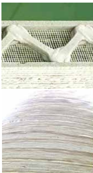
Рис. 2. Склеювання та прокладення пластикових сіток між 2 панелями
